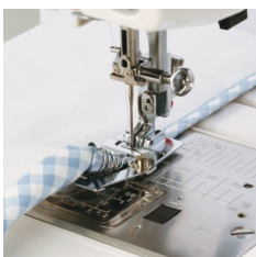
200-313-027 Pied pour pose de biais - pied à border
