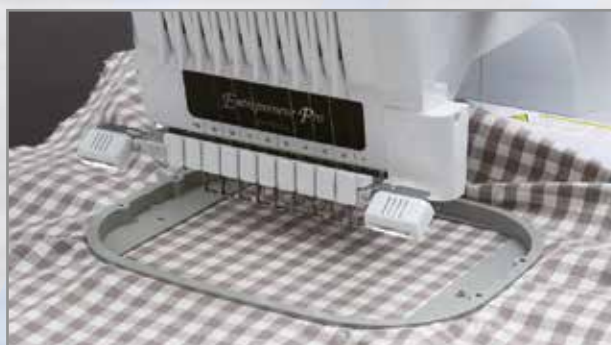
Cadre carré pour faciliter l'alignement des motifs de Quilting et autres positions de broderie
