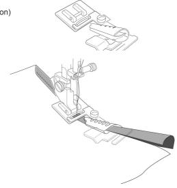
Le pied pour pose de biais facilite la pose de biais pré pliés ou de rubans réalisés par vos soins au bord de n'importe quel projet. Il est équipé d'un petit entonnoir permettant de plier et de guider le biais sur le bord du tissu avant d'atteindre l'aiguille. Le pied pour pose de biais peut être utilisé autant avec le point zigzag, qu'avec des points décoratifs ou encore un point droit.
