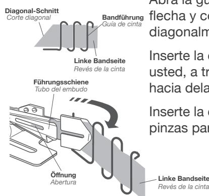
Ziehen Sie 5 cm (2") des Bandes aus der Mündung der Schiene heraus und falten Sie den Streifen im rechten Winkel.
