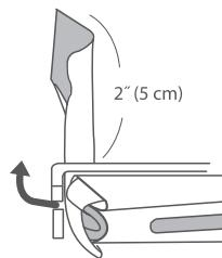
Faites sortir 5 cm (2") de biais hors du tube et pliez le biais à angle droit.
