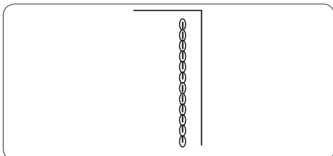
Ce point solide et durable est conseillé pour les travaux exigeant élasticité et solidité afin d'assurer confort et durabilité.
