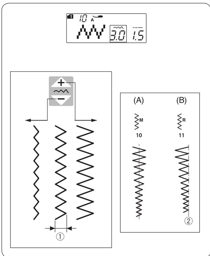
(A): Le motif numéro 10 (mode 1) a une position fixe de piqûre de l'aiguille au centre. La largeur du point varie de manière symétrique.
