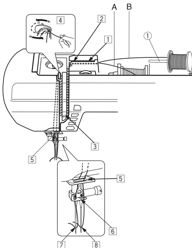
Insérez la broche porte-bobine supplémentaire dans le trou à côté de la broche porte-bobine horizontale.
