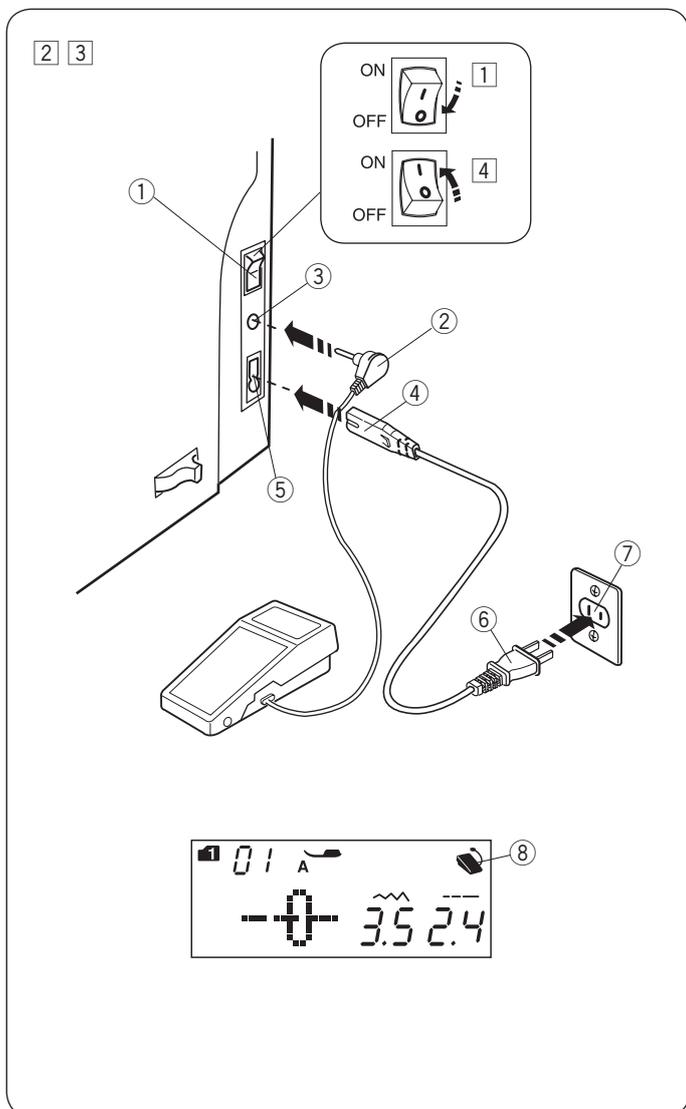
Si vous souhaitez utiliser la pédale de commande, insérez le connecteur à broches dans la prise de la machine.
