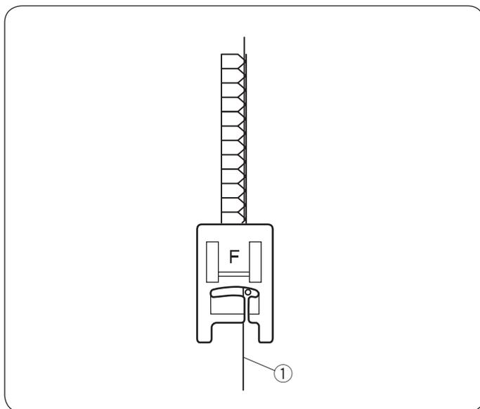
Inspiré des points Overlock industriels, ce point est parfait pour assembler et finir les tissus en une seule opération. Il permet de réaliser des côtelés sur les tricots sans déformer le vêtement.
