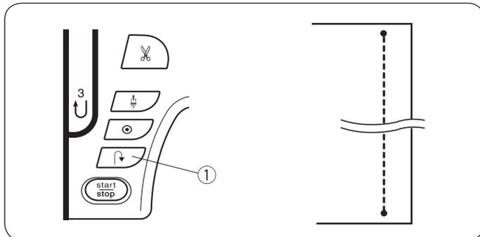
Ce point spécial est utile lorsqu'un point de blocage invisible est nécessaire. Abaissez l'aiguille à proximité du bord avant du tissu.
