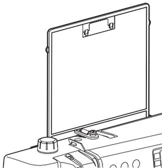
Les fentes frontales ② sur la fixation sont installées pour la position d'affichage. Tirez vers le haut et retirez le tableau des points des fentes arrière. Faites glisser le tableau des points vers le bas entre les fentes avant.
