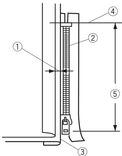
2 Attachez le pied à fermeture éclair. Réglez la position de piqûre de l'aiguille à 7,5 - 8,5 si nécessaire. Abaissez le pied au-dessus de la fin de l'ouverture de la fermeture éclair afin que l'aiguille pique le tissu à côté du pli et du ruban de fermeture. Cousez le long de la fermeture éclair en guidant les dents de la fermeture le long du bord latéral du pied.
