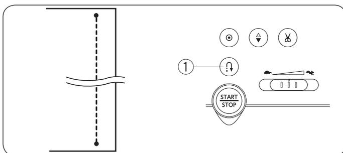
Ce point spécial est utilisé lorsqu'un point d'arrêt invisible est nécessaire.
