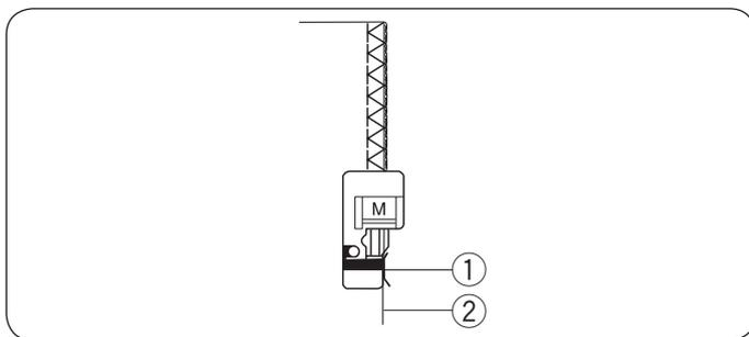
Ce point peut être utilisé simultanément pour les assemblages et les surpiqûres. Utilisez ce point quand vous n'avez pas besoin d'ouvrir les assemblages à plat. Placez le bord du tissu à côté du guide du pied et cousez.
