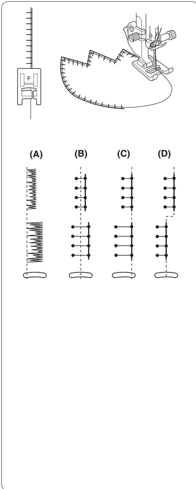
Placez une applique sur le tissu et maintenez-la en place au moyen d'un bâti ou utilisez un entoilage thermofusible pour que l'applique reste bien en place.
