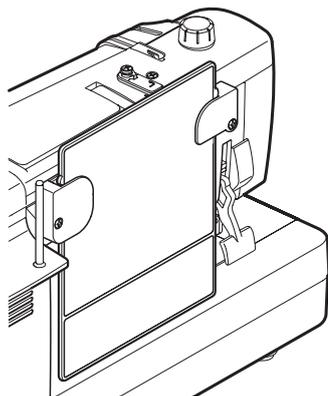
Les fentes ① à l'arrière de la fixation sont installées pour la position de stockage. Faites glisser le tableau des points vers le bas entre les fentes arrière jusqu'à l'arrêt du tableau des points.
